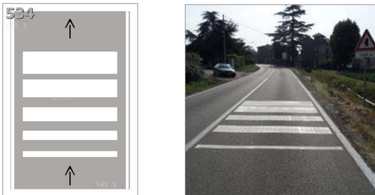
I rallentatori ad effetto ottico sono costituiti da applicazione in serie di almeno 4 strisce trasversali realizzate in vernice rifrangente con larghezza crescente nel senso di marcia come da schema allegato al Regolamento del Codice della Strada (Fig. II.473 art.179). In generale vengono realizzati in gruppi di tre distanziati di 15 metri a partire dal punto in cui si vuole ottenere il massimo rallentamento.
